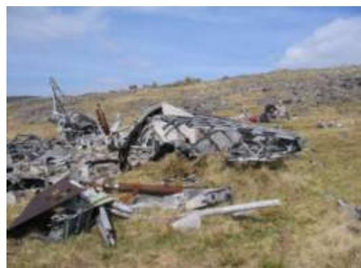
Figure 69. Exemples de crash d'un Wellington (on voit la structure géodésique, les croisillons en aluminium recouverts de « textile irlandais ») photographié par un officier allemand ou encore visible dans le sud du Pays de Galles . © aircrewremembered.com, breconbeacons.wordpress.com
