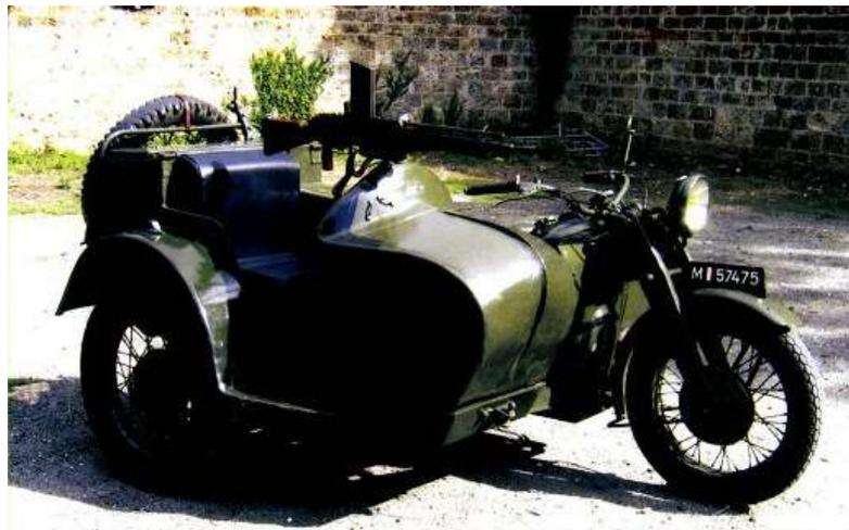
**Figure 29. Moto tout terrain 800cm<sup>3</sup> GNOME ET RHÔNE AX 2 avec side RM type Dragons Portés.
