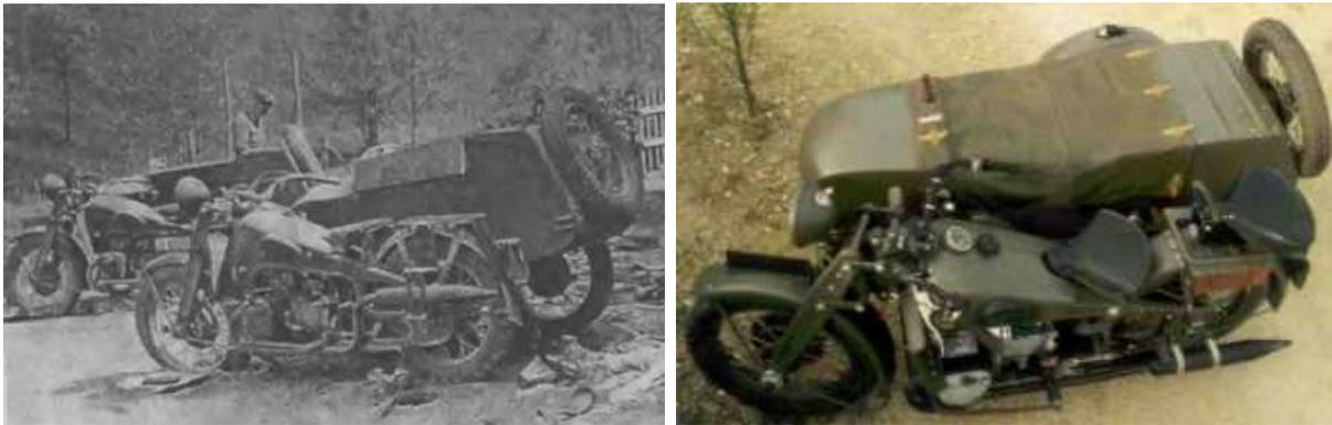
Figure 31. La première photo allemande à Crupet où les side-cars semblent bâchés... et une Gnome et Rhône 800 AX 2 à side-car tracté Bernardet bâché (A Crupet, elles n'avaient pas de siège passager). © Crup'Echo, moto-collection.org
